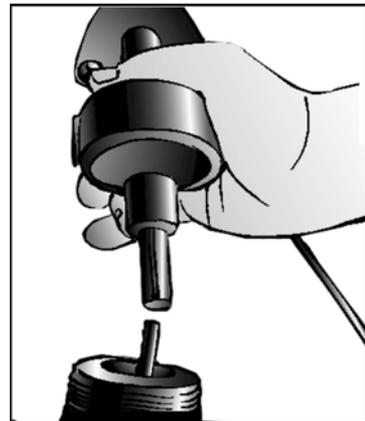
**Действие 7.** Закройте конец трубного ниппеля маскировочной липкой лентой. Наложите материал для уплотнений на поверхность верхнего шарнира нового привода, отверстия для винтов и кабель. Пропустите кабель привода через отверстие диаметром 5/16" и прикрепите верхний шарнир привода к транцу с помощью монтажных винтов. Захватите корпус цилиндра обеими руками и надежно затяните его (по часовой стрелке). Повторите это для другой стороны. Проложите кабель к штурвалу.
